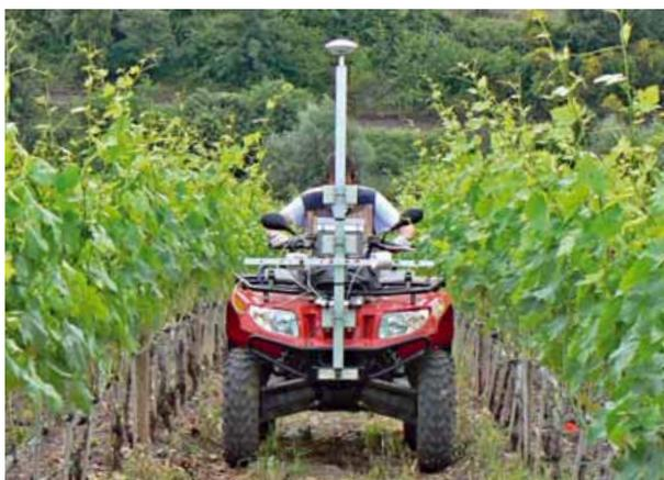
Passaggio del trattore munito di sensori a infrarossi all'interno del vigneto per il rilievo dei dati
